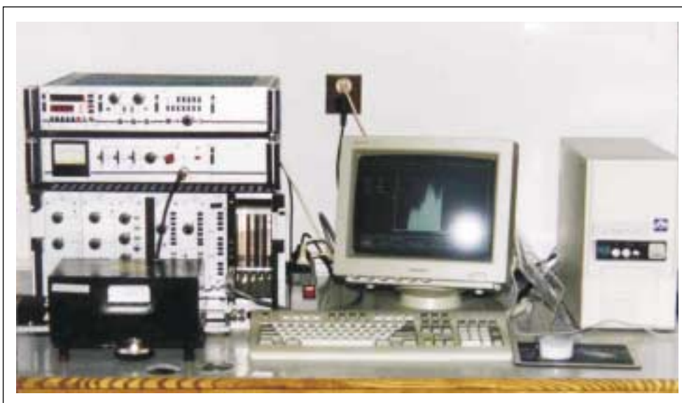
Rys. 18. Zestaw laboratoryjny do badania produktów zużycia węzłów tribologicznych w systemach olejenia i w układach hydraulicznych statku powietrznego oparty na metodzie spektrometrycznej
