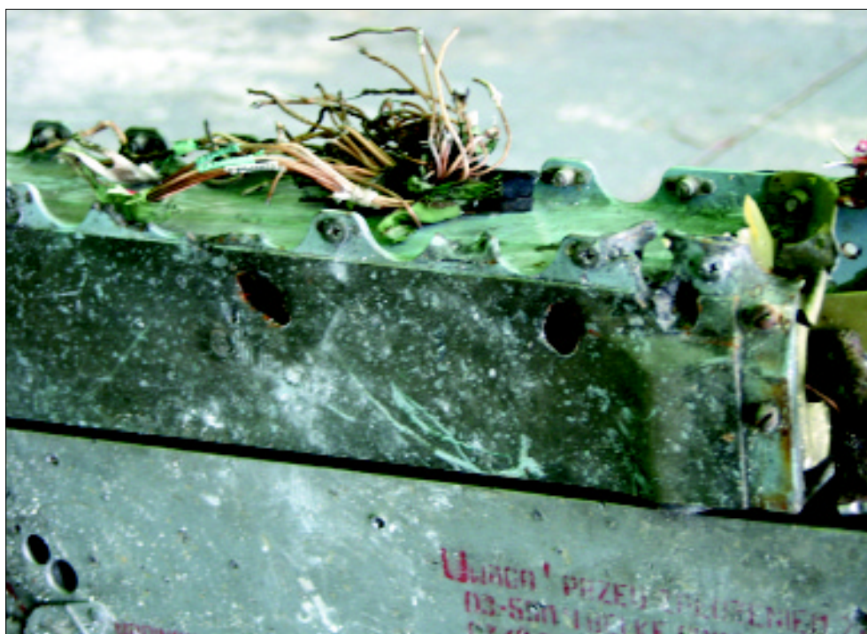
Przebiecia i ślady uderzeń odłamków z prawej strony belki pośredniej i belki uniwersalnej BD-3-57MTA podwieszenia nr 5
