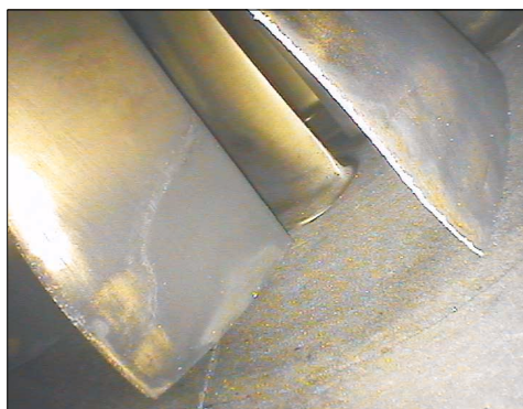
Rys. 3. Uszkodzenie erozyjne krawędzi natarcia pióra łopatki pierwszego stopnia wirnika sprężarki z widocznym skrzyśnięciem profilu
