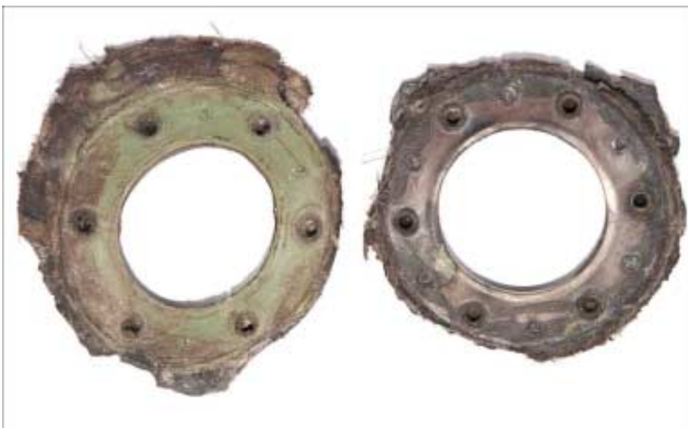
Kołnierze gumowych zbiorników paliwa (z prawej – kołnierz przyłącza, z którego prawdopodobnie nastąpił wyciek)
