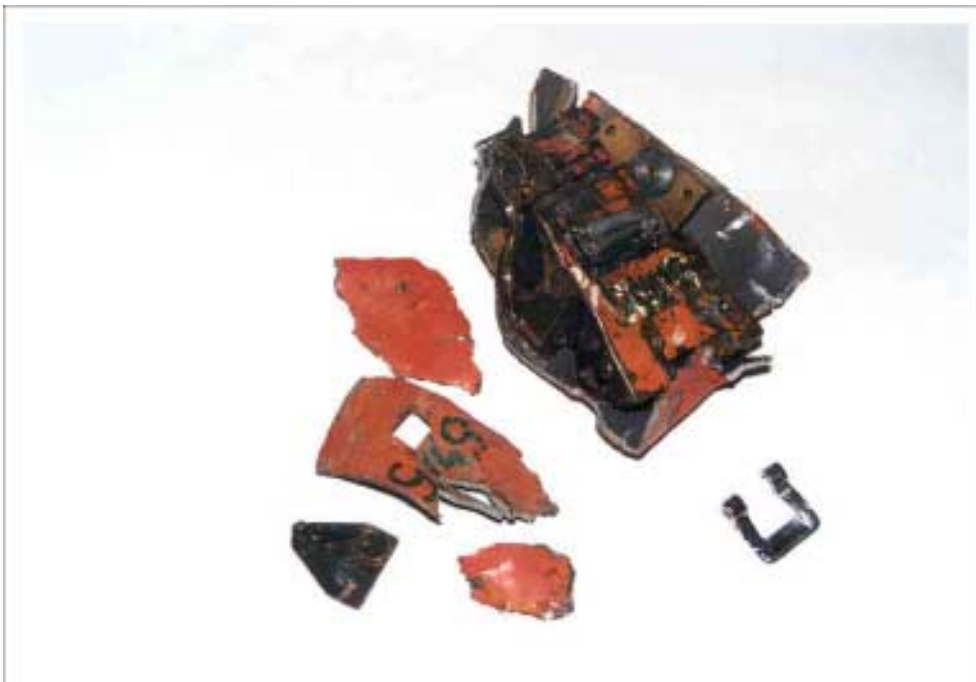
Odnaleziona kaseta rejestratora parametrów lotu SARPP-12GM
