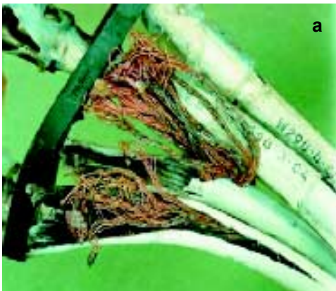
Przykłady degradacji izolacji przewodów elektrycznych: a) rozwarstwienia cieplne izolacji; b) erozja izolacji Źródło: G. Slenski, J. Kuźniar: Wire Integrity Field Survey of USAF Legacy Aircraft . NATO R&T Organization Symposium on Aging Mechanisms & Control. Manchester 2001 (a); FAA aging transport non-structural system plan . U.S. Department of Transportation Federal Aviation Administration, 1998 (b).
