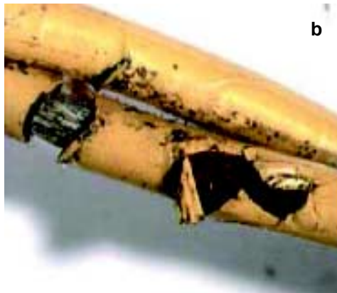
Przykłady degradacji izolacji przewodów elektrycznych: a) rozwarstwienia cieplne izolacji; b) erozja izolacji Źródło: G. Slenski, J. Kuźniar: Wire Integrity Field Survey of USAF Legacy Aircraft . NATO R&T Organization Symposium on Aging Mechanisms & Control. Manchester 2001 (a); FAA aging transport non-structural system plan . U.S. Department of Transportation Federal Aviation Administration, 1998 (b).
